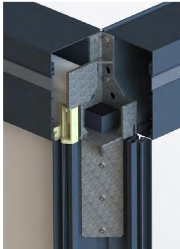
La fixation haute de nos pergolas est prévue avec des équerres en acier galvanisé. Elles relient le poteau vertical à l'ossature. Visserie 100% inox
